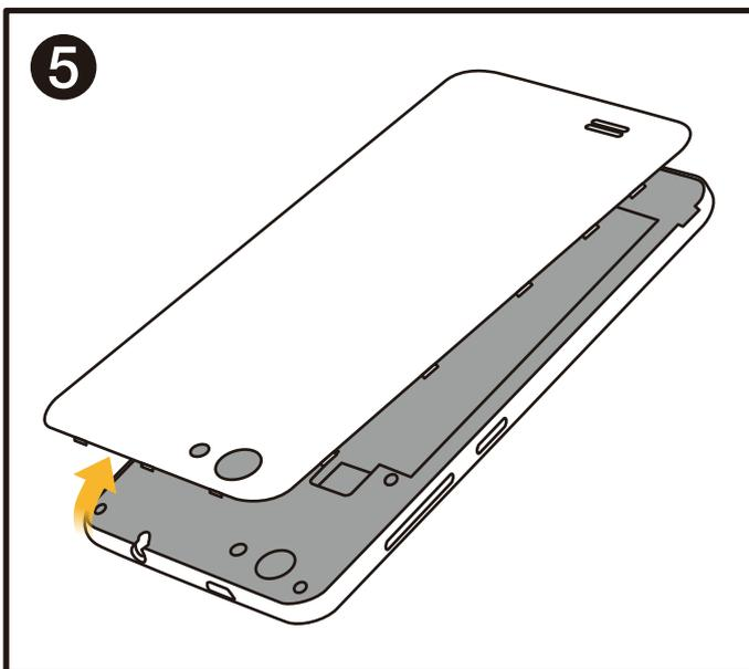
残りの本体とカバーを留めているツメを外すように、ゆっくりと持ち上げてカバーを取り外します。その際に、カバー部分のツメを折らないようにご注意ください。
